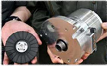
県内企業が開発した電気自動車用モーター(右)とドローン用モーター(左)
